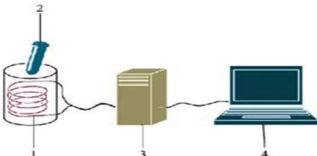
Montage expérimental du Pr. J. Benvéniste pour la mesure des signaux électromagnétiques émis par des solutions diluées. 1. Bobine en fil de cuivre; 2. Solution, 1 ml en tube scellé plastique; 3 et 4. Amplificateur et ordinateur
