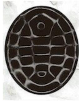
Figure de sable sur une plaque ovale stimulée par une fréquence sonore de 1088 Hz.
