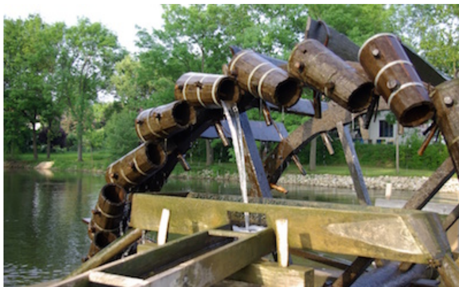
Une noria ou roue à godets, sur la rivière Regnitz, à Erlangen en Bavière, Allemagne. Merci à Wikipedia .
